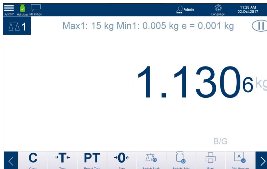
Figura 2-31. Visualizzazione del peso per taratura. Piattaforma di pesatura IDNet di classe II
