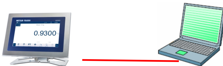
Figura B-1: Collegamento dell'IND900 a un PC con un cavo crossover
