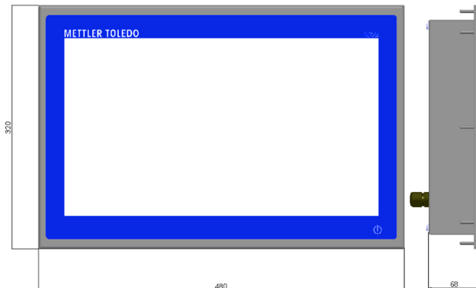
Figura 1-6. Dimensioni del terminale IND970-19, montaggio su pannello
