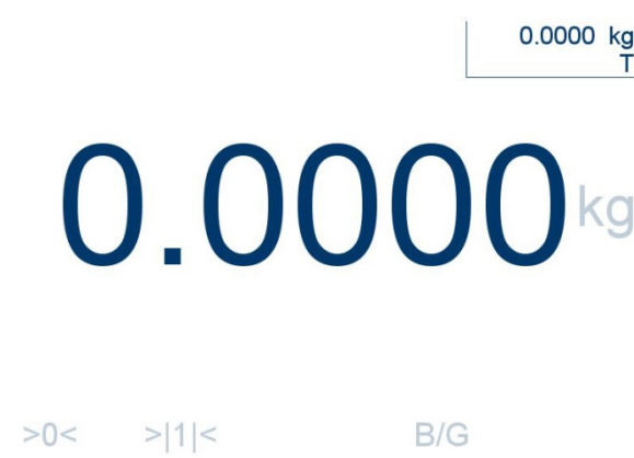
Figura 3-45. Visualizzazione della tara quando la visualizzazione ausiliaria è impostata su Tara sempre
